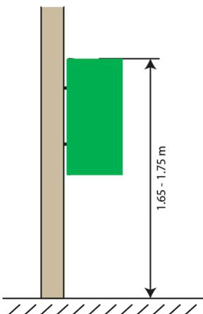
Es wird eine Montagehöhe von 1.65 m bis 1.75 m empfohlen bezogen auf die Oberkante des SmartCase.
